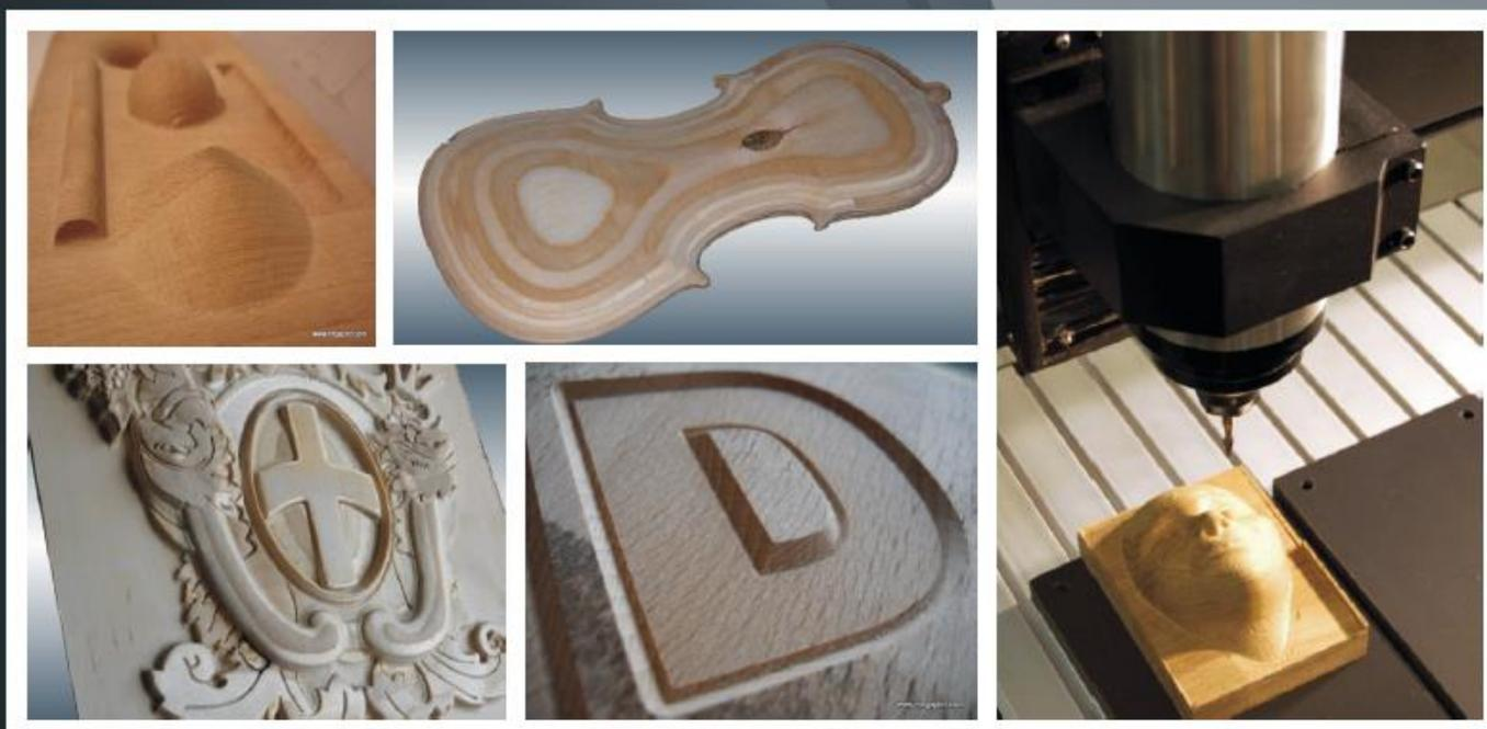
НАШИ МАРШРУТИЗАТОРЫ С ЧПУ СЕРИИ XMD идеально подходят для резки, фрезеровки и гравировки любых 2D и 3D форм из дерева, фанеры, оргстекла, поликарбоната, ПВХ, Алюминия, латуни, бронзы, Dibond, пенопластов EPS и XPS и многих других материалов.
